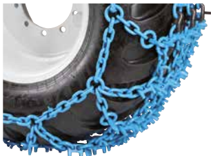
Eks: Korrekt tilspenning for hardt underlag
